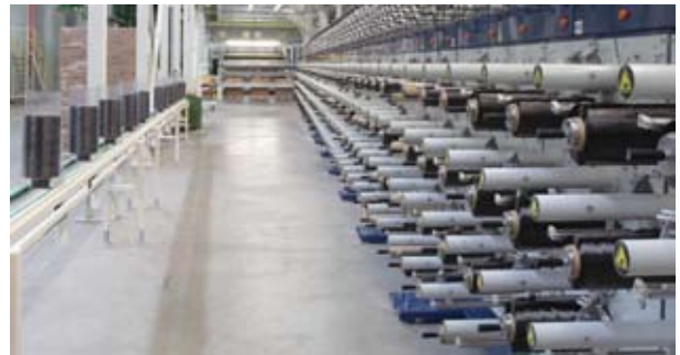
图2 AKSA公司碳纤维生产线收丝设备
